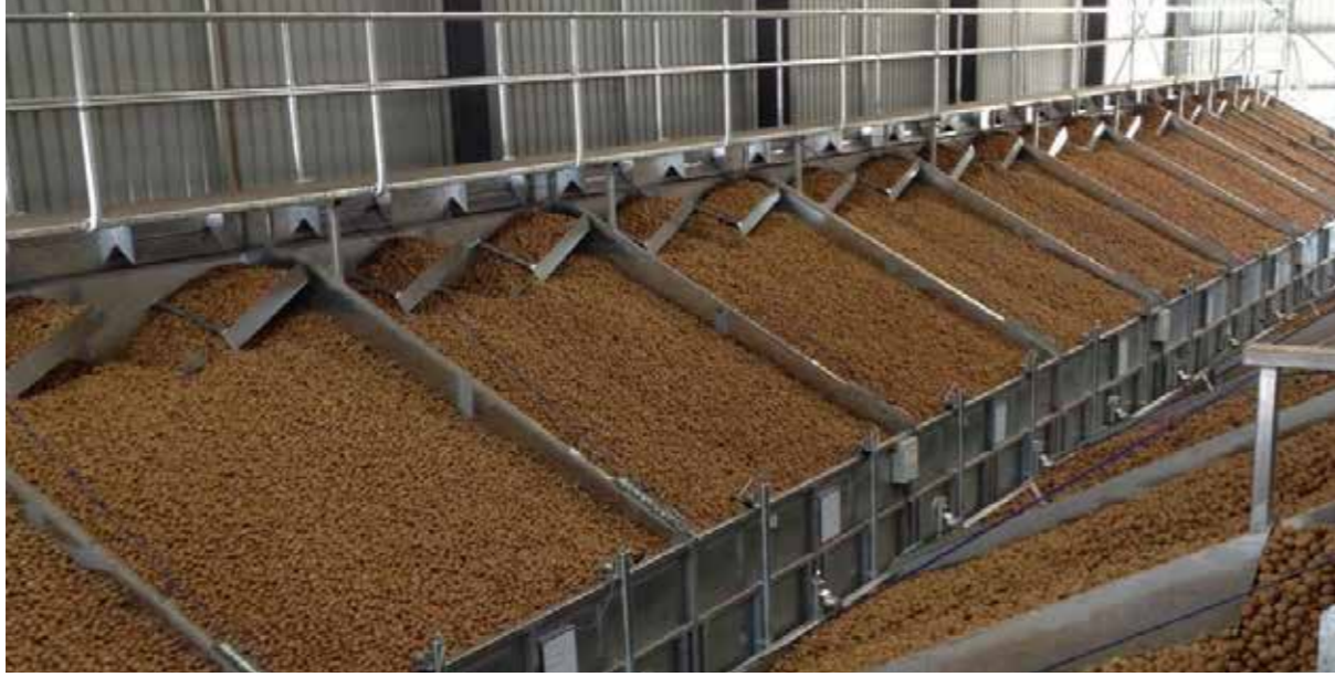
Şekil 17. Cevizin Kapalı Ortamda Isı ile Kurutulması
